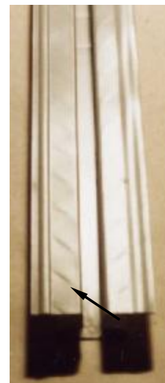
Рис. 1.37. Линии Чернова-Людерса (полосы скольжения) на полке профиля
