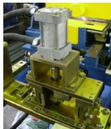
Рис. 4.28. Пресс пневматический для резки профиля на мерные длины
