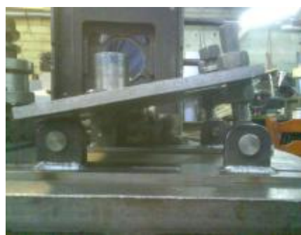
Рис. 4.27. Правильные устройства: а – устройства для обеспечения прямолинейности профиля; б – устройство для придания кривизны профилю
