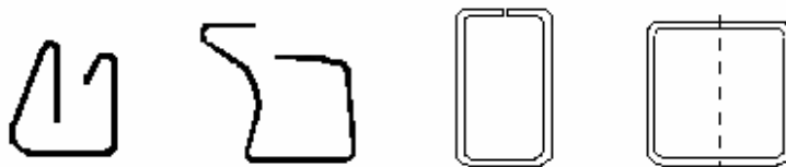
Рис. 1.17. Полузакрытые и замкнутые профили, используемые при производстве мебели
