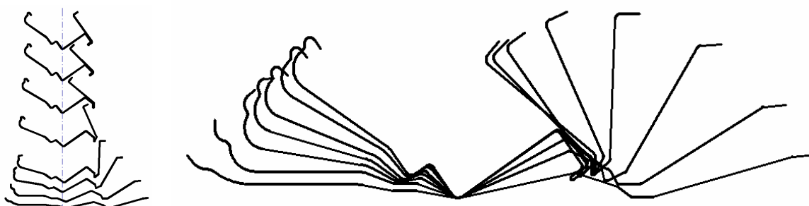
Рис. 4.6. Расположение сечения профиля в роликовом калибре и схема формообразования
