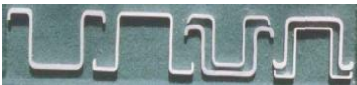
Рис. 1.12. Профили из алюминиевых сплавов, изготовленные методом стесненного изгиба в ОАО «Ульяновский НИАТ»
