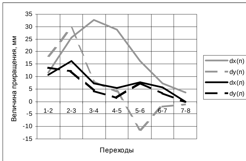
Рис. 4.9. Перемещения точек периферийных элементов
