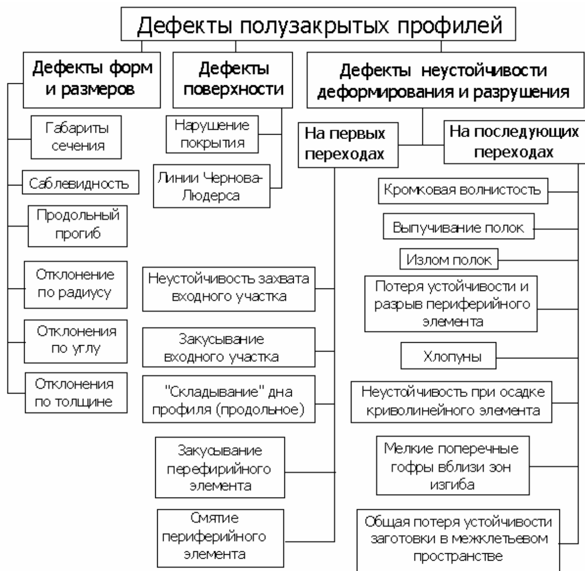
Рис. 1.34. Классификатор дефектов полузакрытых профилей
