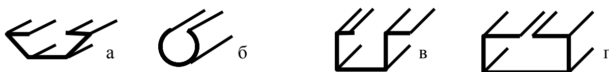
Рис. 1.11. Профили для автомобилестроения: а – молдинг; б – стеклоподъемник; в – элемент жесткости кузова; г – несущий элемент навесного багажника
