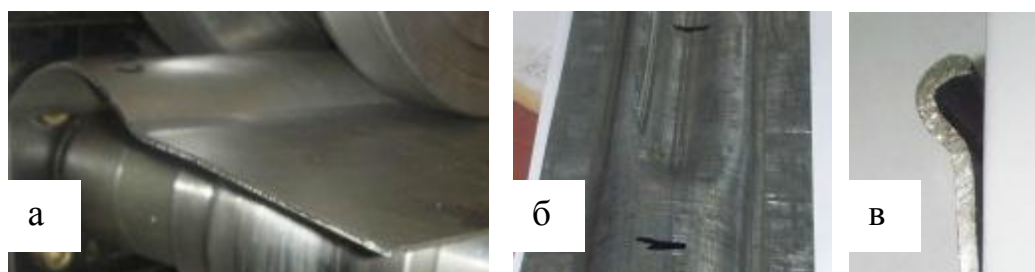
Рис. 3.29. Элементы профиля при формовке: а – дугообразный рифт; б – двугорбый рифт; в – полукруглая отбортовка
