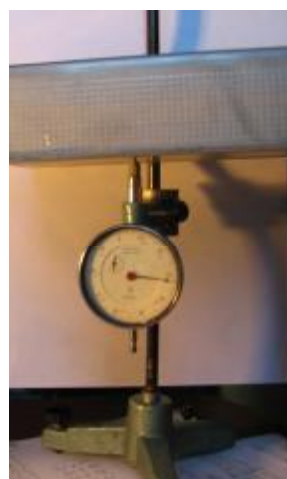
Рис. 3.37. Индикатор часового типа и его монтаж на стойке для замера величины прогиба донной части профиля
