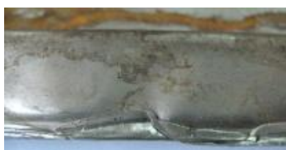
Рис. 1.42. Смятие периферийного элемента
