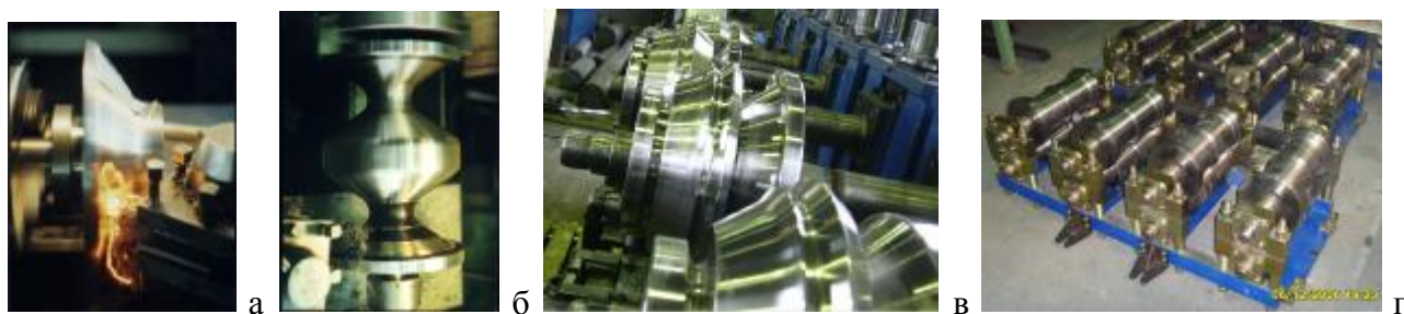
Рис. 4.22. Роликовая оснастка: а – черновая токарная обработка ролика; б – чистовая обработка ролика; в – комплект роликов для изготовления профиля обрамления дверей; г – оснастка для изготовления профиля типа «сайдинг» в сменных кассетах
