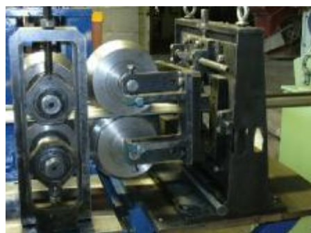
Рис. 4.27. Правильные устройства: а – устройства для обеспечения прямолинейности профиля; б – устройство для придания кривизны профилю
