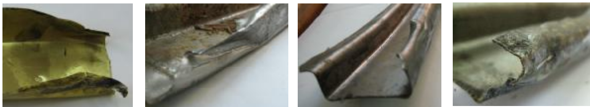
Рис. 1.38. Неустойчивость захвата входного участка заготовки
