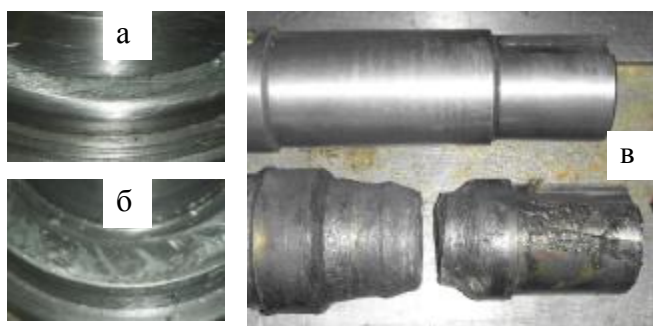
Рис. 3.30. Налипание цинкового покрытия на формующие ролики (а, б) и перетирание вала из-за чрезмерной нагрузки, связанной с налипанием цинкового покрытия (в)
