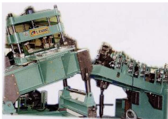
Рис. 1.28. Станок для производства автомобильных деталей с продольной кривизной
